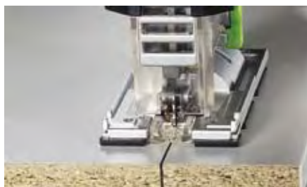
Ausrissarme Schnitte mit dem einsetzbaren Splitterschutz.
