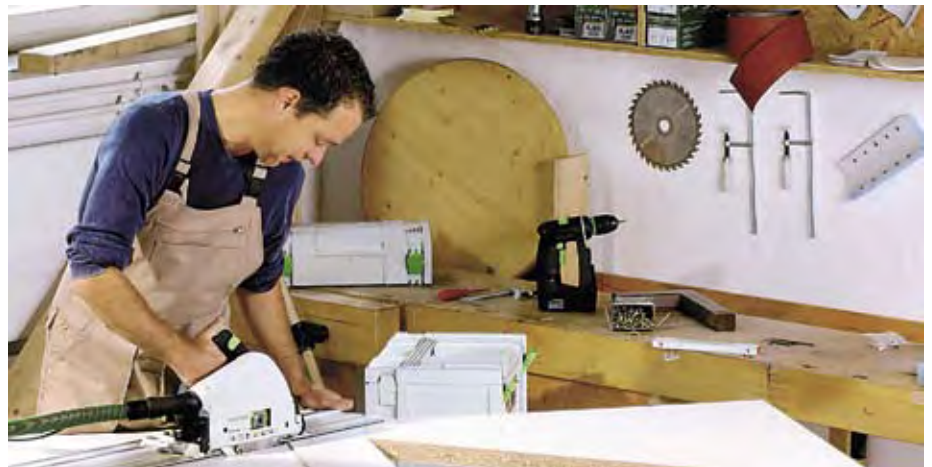
Praktisch für jeden Ausschnitt: Mit einer Tauchsäge von Festool und der Führungsschiene schneiden Sie sicher und exakt – auch bei komplizierten geometrischen Formen.
