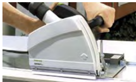
Optimierte Staubabsaugung dank geschlossener Absaughaube und Abdichtbürste.
