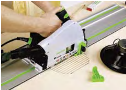
Beidseitig ausrissarm Sägen, dank Führungsschiene und aufsteckbarem Splitterschutz.
