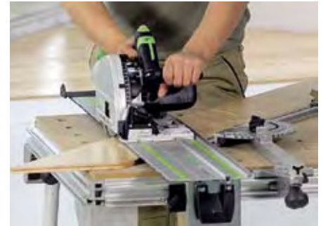
Sicher gespannt und bestens geführt: die Tauchsägen in Kombination mit dem MFT.
