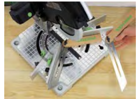
Mit Schmiege und patentiertem Anschlag: Mit der SYMMETRIC exakt und einfach Leisten sägen.
