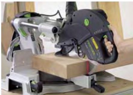
Die KAPEX KS 120 ist kraftvoll und präzise: dank MMC Electronic und Doppellinienlaser.
