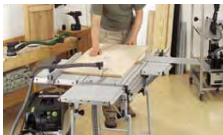
Längsschnitte sind kein Problem – mit passendem Zubehör auch für extra lange Bretter.
