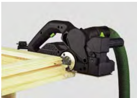
Unbegrenzt tief falzen durch die einseitige Lagerung des Hobelkopfes.
