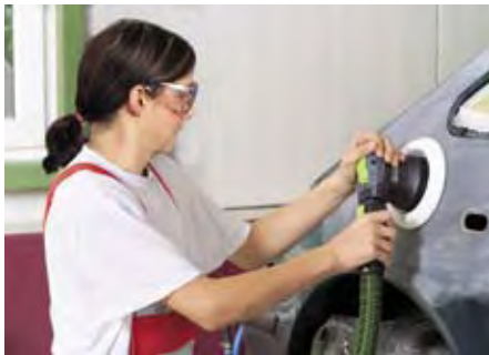
Abschleifen von Karosserie-Teilen. Dafür sind die Druckluft-Exzentrerschleifer von Festool ideal.
