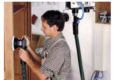
Dank des geringen Gewichts und der hohen Handlichkeit sind die LEX 2 Exzentrerschleifer auch sehr gut geeignet für die Arbeit an senkrechten Flächen.
