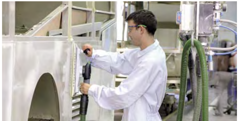
Speziell für die Werkstatt entwickelt: Die LEX 2 Exzentrerschleifer und das IAS 2-System mit Absaugmobil.
