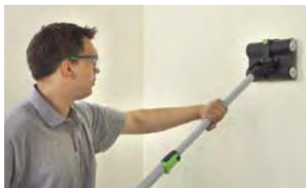
Durch die Tiefeneinstellung wird der Untergrund geschont.
