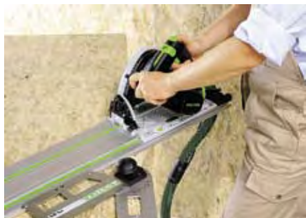
Einfaches Übertragen von Winkeln auf das Werkstück, mit Kombischmiege und Führungsschiene.
