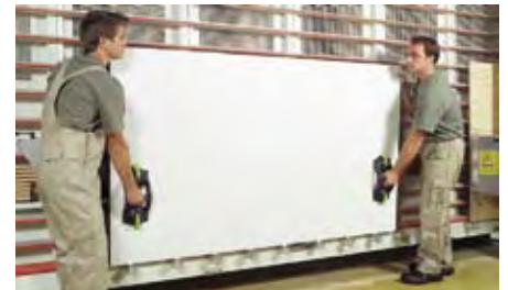
Mit dem GECKO lassen sich glatte und unhandliche Werkstücke sicher und bequem fassen.
