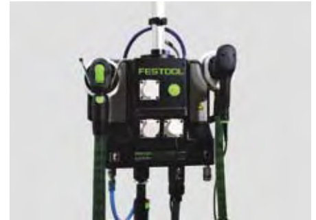
Mit der Energiebox sind Strom, Druckluft und Absaugung stets parat.
