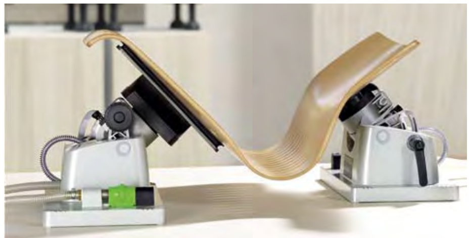
Geschwungene Werkstücke zu spannen ist für das Vakuum-Spannsystem VAC SYS kein Problem.
