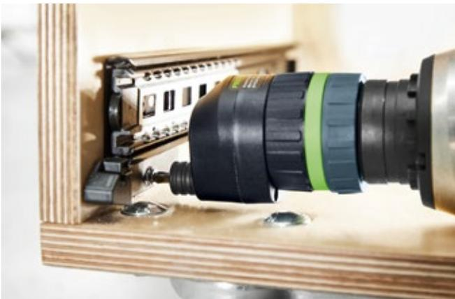
**Percer et visser près des bords.** Percer de travers ou visser à la main parce que l'outil ne peut pas être mis en place correctement ? Une possibilité uniquement envisageable comme plan B. La meilleure solution : le module excentrique EX-UNI de Festool.
