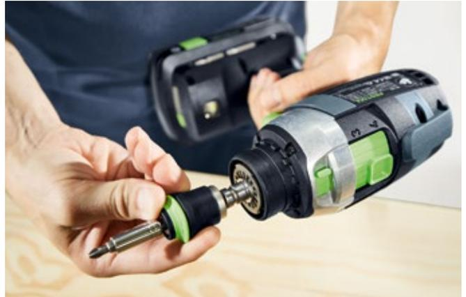
**Changement d'outil rapide et simple.** Le mandrin porte-outil CENTROTEC est plus petit de 50 % et plus léger de 80 % qu'un mandrin de perçage. Lors du changement d'outil, CENTROTEC se révèle d'une flexibilité et d'une simplicité d'utilisation inégalables.
