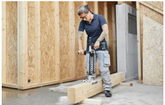
**Serrage à la main.** Le mandrin de serrage rapide se met en place sans outil sur la machine et peut être serré à la main. Grâce à sa plage de serrage de 1,5 bis 13 mm, il affronte également sans crainte les opérations de perçage extrêmes.
