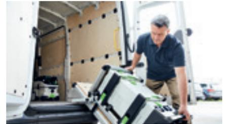
Einfache Verladung ins Fahrzeug durch nur eine Person, dank winkelverstellbarem Schubbügel, Gleitflächen und Griffmulde am Basiselement.
