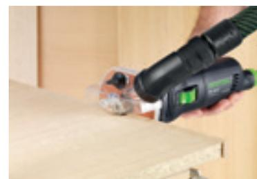
Bündigfräsen von Kunststoff- oder Massivholz-
