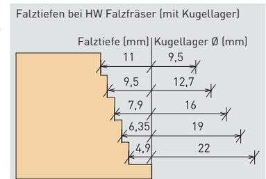
\*\* Lieferumfang: 1 Kugellager Ø 12,7 mm mit Falztiefe 9,5 mm
