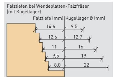
\* Lieferumfang: Kugellager-Set von Ø 9,5 mm bis Ø 22 mm
