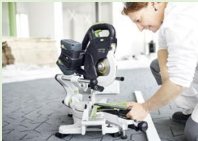
**Reporter les angles sans faire d'erreur.** Grâce au dispositif de réglage précis de la KAPEX, la fausse-équerre permet de reporter sans risque d'erreur l'angle de coupe souhaité.
