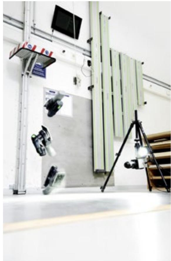
↑ Lors des essais réalisés à Wendlingen, les ponceuses portatives sans fil Festool doivent résister à des chutes très dures.
