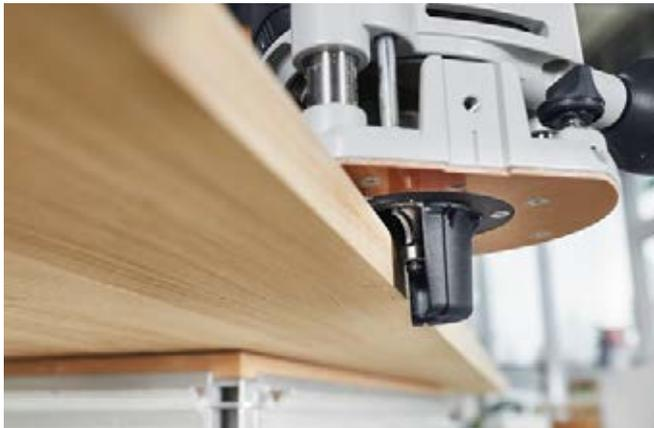
**Propreté garantie.** Lors du fraisage de chants, le dispositif d'évacuation de copeaux KSF-OF 1010 fourni élimine les copeaux à la source. L'optimisation des performances d'aspiration durant le fraisage atteint ainsi jusqu'à 98%.
