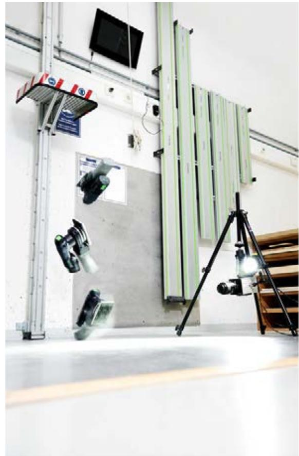
↑ Lors des essais réalisés à Wendlingen, les ponceuses portatives sans fil de Festool doivent résister à des chutes très dures.
