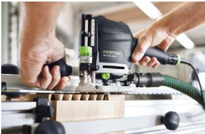
**Traditionnel et rationnel.** En combinaison avec le système d'assemblage VS 600, vous atteignez la perfection et réalisez des poutres manuelles, par ex. lors de la réalisation de queues droites, de queues d'aronde ultra-précises ou d'assemblages chevillés.
