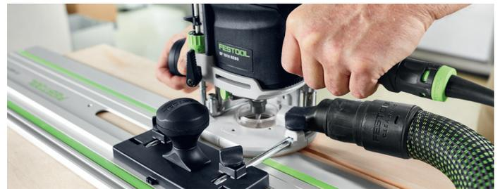
**Toujours garder le cap.** L'adaptateur de rail de guidage pour la défonceuse et le rail de guidage vous apporte la garantie de fraiser parfaitement droit, par ex. lors du rainurage, y compris sur plusieurs mètres si nécessaire.
