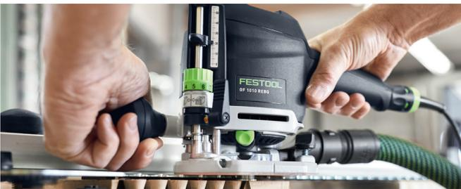
**Traditionnel et rationnel.** En combinaison avec le système d'assemblage VS 600, vous atteignez la perfection et réalisez des poutres manuelles, par ex. lors de la réalisation de queues droites, de queues d'aronde ultraprécises ou d'assemblages chevillés.
