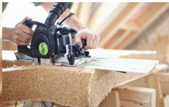
Präzision pur: Exakt, leicht, tief für den präzisen Zugschnitt von Holz und Dämmstoffen – die Schwertsäge UNIVERS SSU 200.
