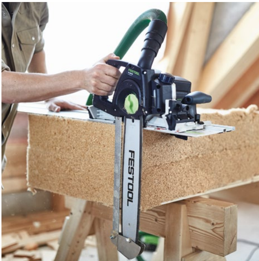
Grösse leicht gemacht: Schwertsäge IS 330 EB – nur 7 kg Gewicht bei einer Schnitttiefe von 330 mm.
