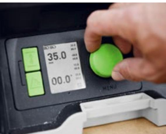
↑ L'écran de la CSC SYS 50 permet d'effectuer un réglage au dixième de millimètre près et de le réutiliser pour plusieurs coupes.
