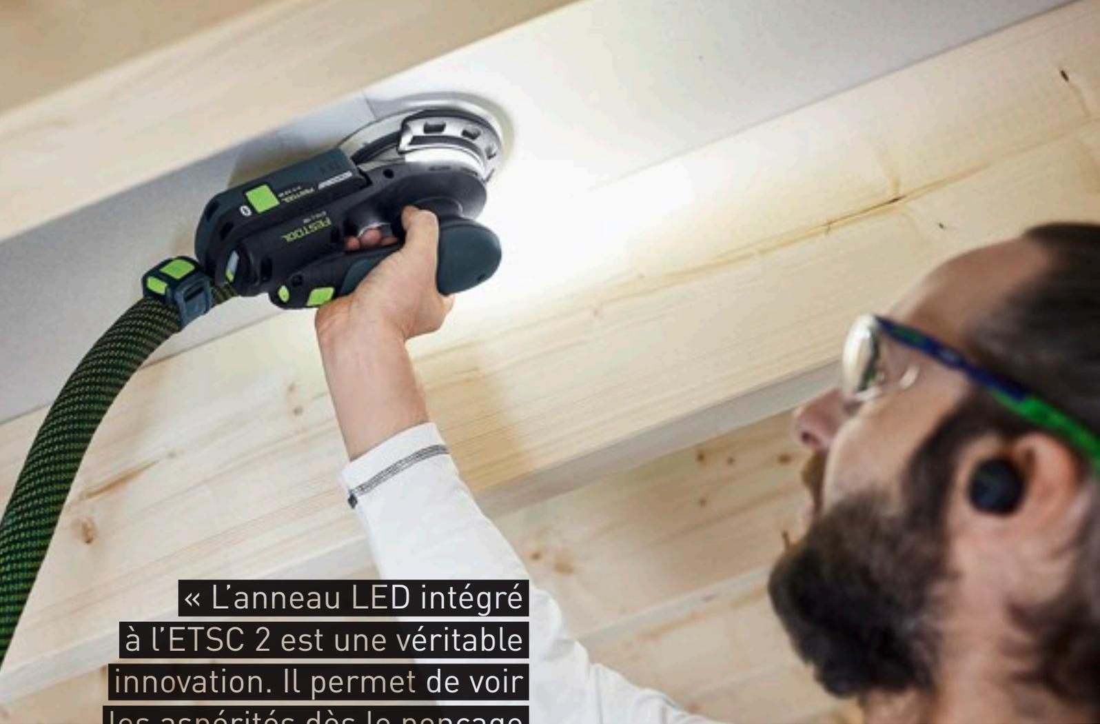
« L'anneau LED intégré à l'ETSC 2 est une véritable innovation. Il permet de voir les aspérités dès le ponçage et d'éviter ainsi des retouches de finition superflues. »
