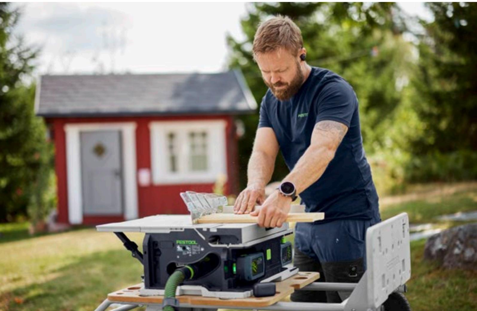
Pour Patrik Hansson, la combinaison d'une scie circulaire sur table sans fil, d'un châssis de transport et d'un aspirateur sans fil fait office d'atelier nomade autonome.
