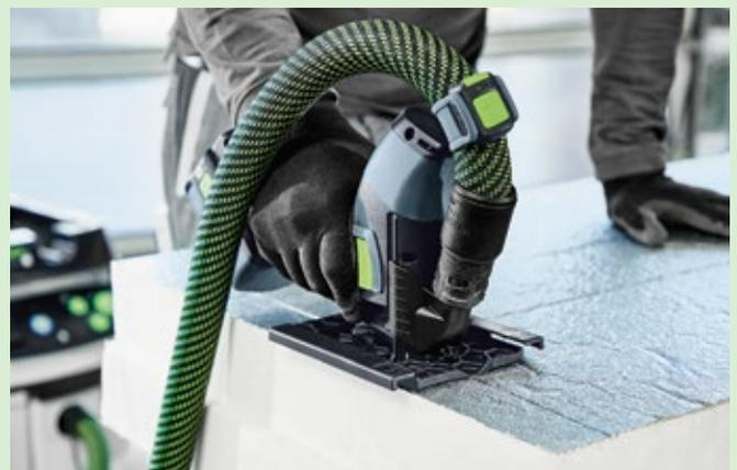
**Pensez à votre santé.** Utilisez toujours un aspirateur lorsque vous découpez des matériaux d'isolation qui produisent de la poussière. L'aspirateur se raccorde facilement à l'ISC 240 au moyen de l'adaptateur d'aspiration et pourra être asservi (pour les variantes Bluetooth).
