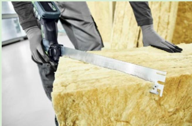
**Découpez à main levée facilement** Légère et ergonomique, la scie pour matériaux isolants vous permet d'obtenir rapidement et simplement les dimensions précises dont vous avez besoin, même avec des matériaux isolants jusqu'à 350 mm.
